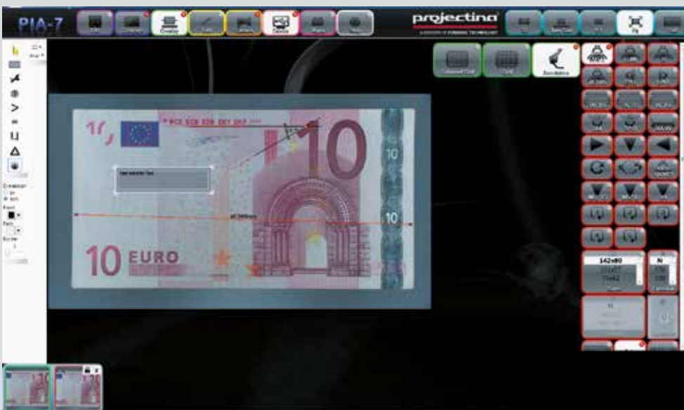
■ Messen von Distanz, Winkel, Kreisdurchmesser sowie Einfügen von Text und Markierungen
