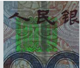
■ Infrarot 740 - 1100 nm Beleuchtung für „anti-Stokes inks“ Untersuchungen
