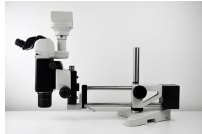
Schweres Doppel - Schwenkarmstativ mit Nikon SMZ18 Stereomikroskop
