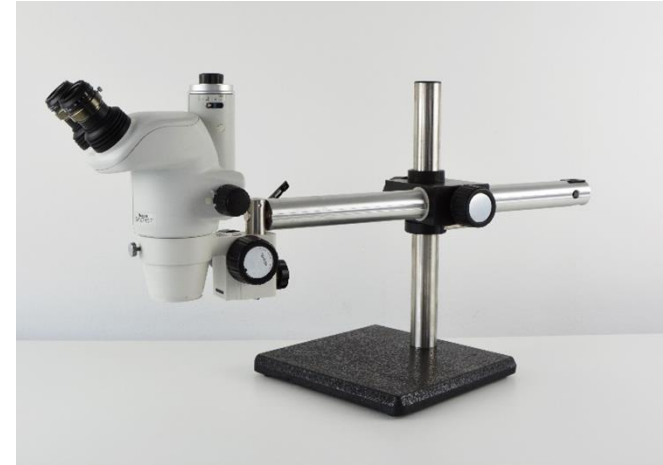
Schwenkarmstativ mit Nikon SMZ745T Stereomikroskop
